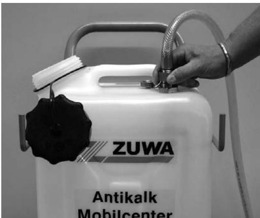
3. Rücklaufschlauch befestigen.
